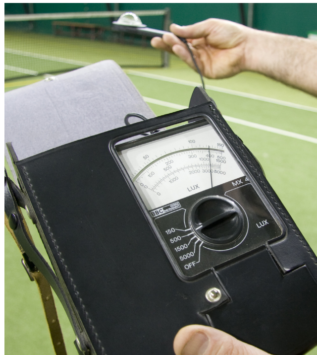
Il luxometro, lo strumento utilizzato per verificare i lux di un impianto di illuminazione. La Fit richiede una media di 400 lux per la Serie A1.
